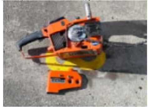
スプロケットカバーの取り外し
